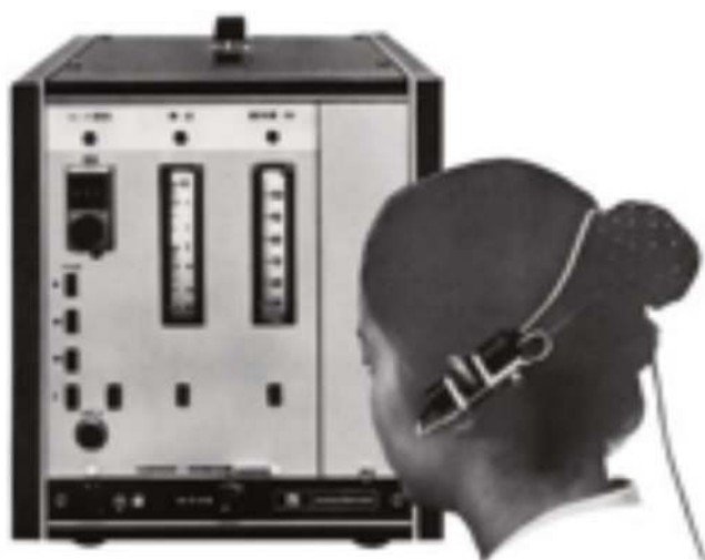
Primeiro oxímetro de pulso com sensor de orelha (OLV 5100)
